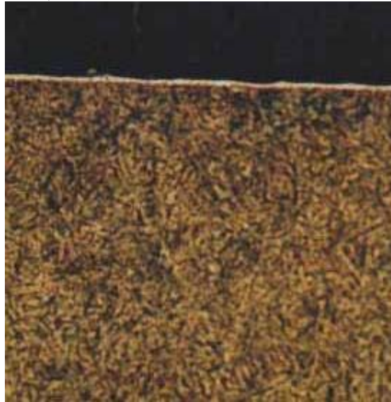
Slika 4. Mikrostruktura čelika C60 vanadiranog pri 950 °C/ 240 min, povećanje 200: 1
